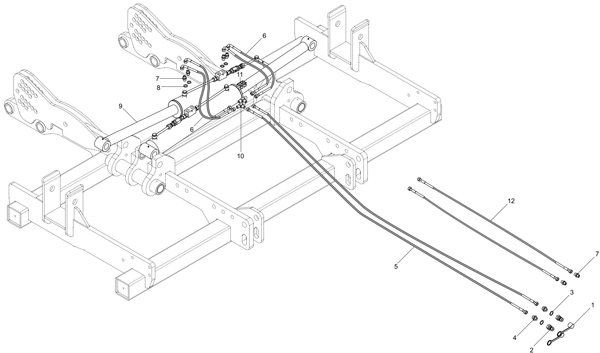
**IMPIANTO OLEODINAMICO TELAIO PIEGHEVOLE UFO 450 / PLANT HYDRAULIC FOLDING FRAME UFO 450 /
