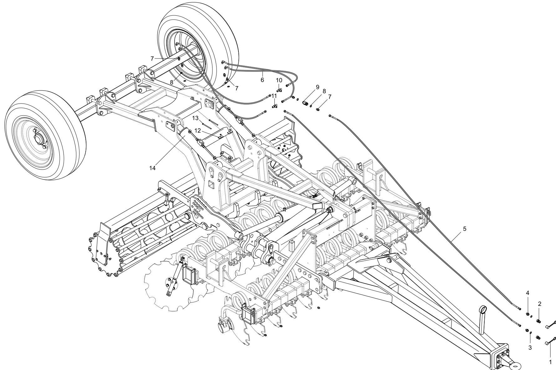
**IMPIANTO OLEODINAMICO CARRELLO UFO 600 (OPZIONALE UFO 450) / PLANT HYDRAULIC CART UFO 600
