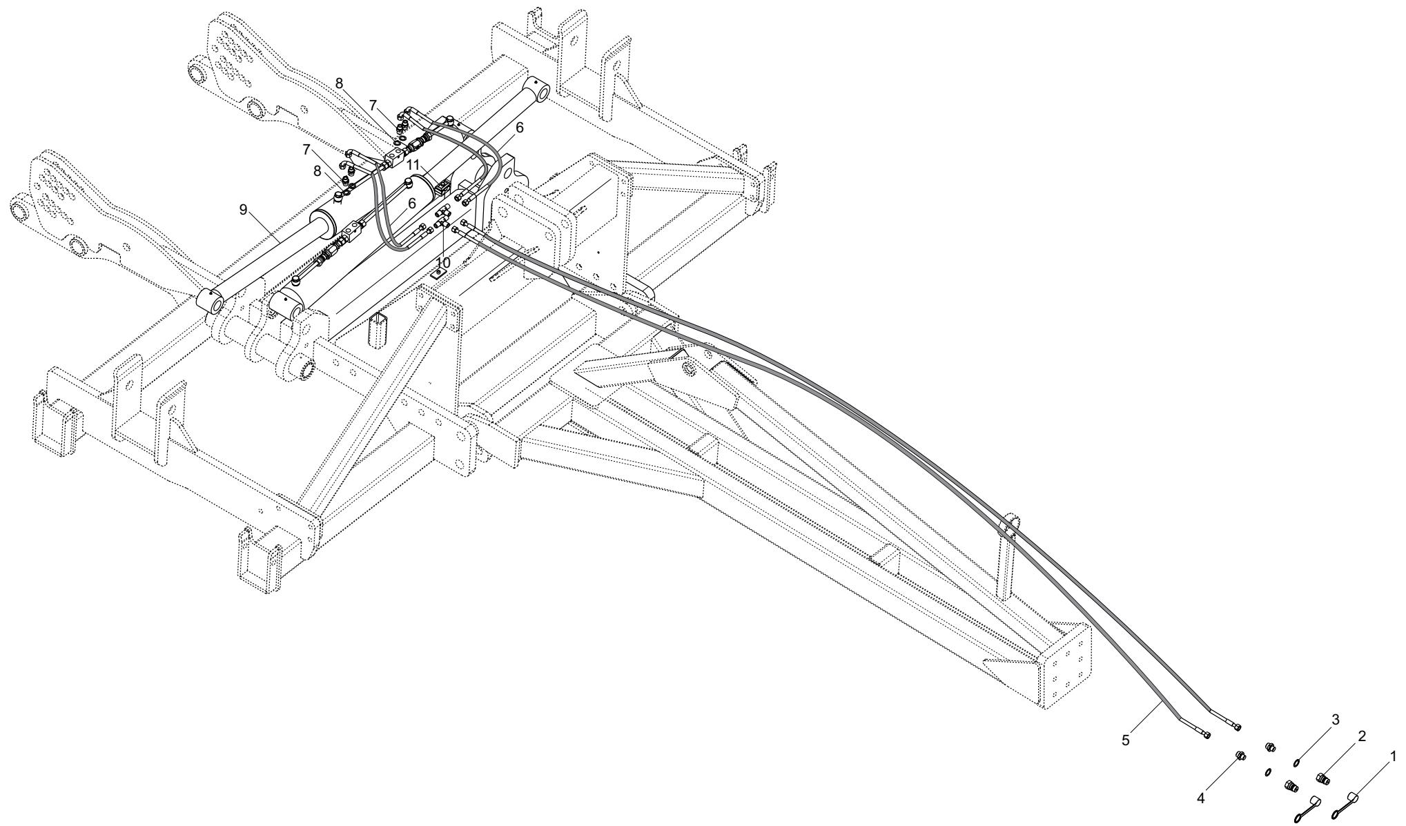
**IMPIANTO OLEODINAMICO TELAIO PIEGHEVOLE UFO 600 / PLANT HYDRAULIC FOLDING FRAME UFO 600 /
