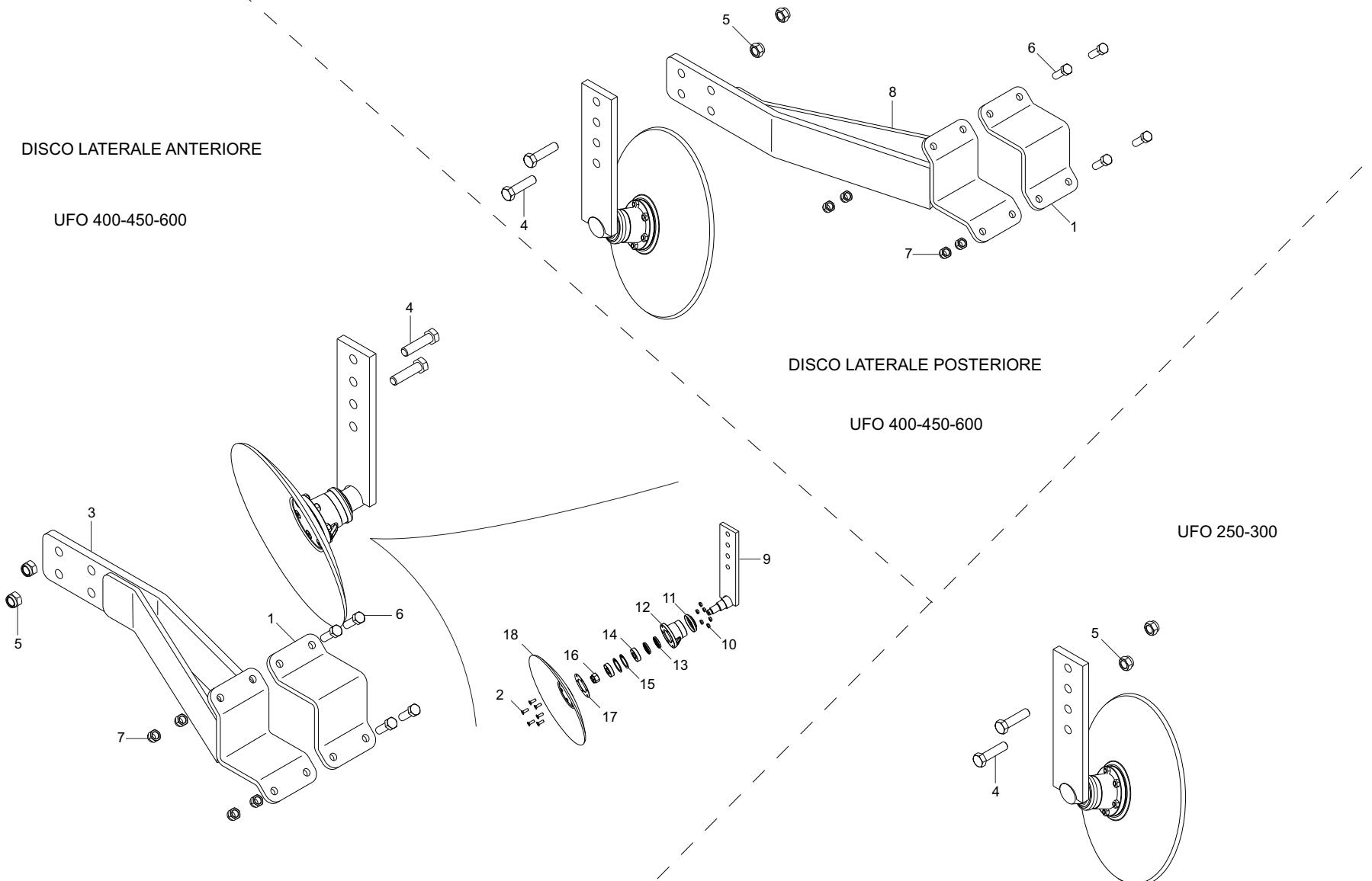
**DISCO LATERALE ANTERIORE E POSTERIORE / DISC FRONT AND REAR SIDE / DISC-VORDER-UND
