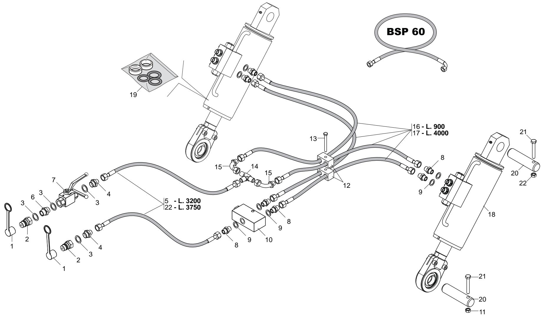
**IMPIANTO OLEODINAMICO TELAIO**
